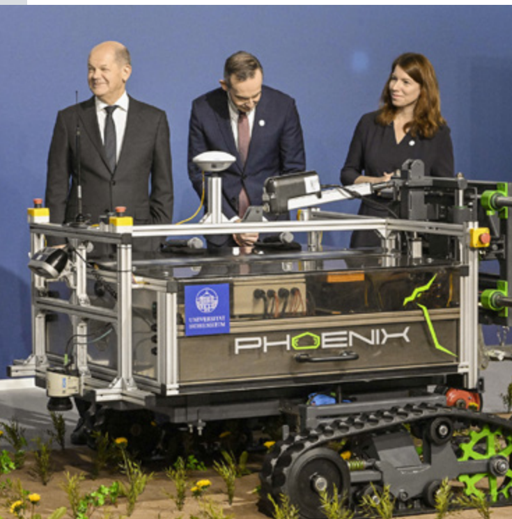
Tysklands förbundskansler Olaf Scholz (till vänster) inspekterar en AI-stödd fältrobot för precisionsodling vid en mässa i december. Linux-styrda, internet of things -uppkopplade Phoenix kan bland annat plöja, så och dispensera gödning och bekämpningsmedel efter plantornas behov. Foto: Tobias Schwarz/Getty Images
